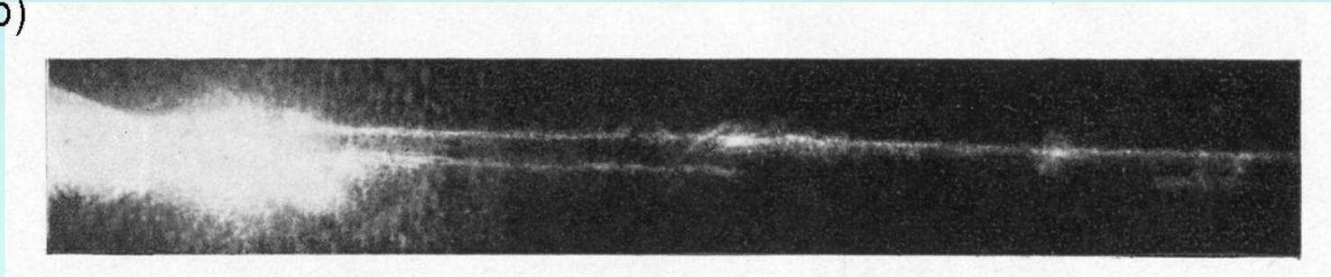
Светящиеся каналы при фокусировке наносекундных импульсов на длине волны 1,06 мкм мощностью 20 мВт в кювету с циклогексаном (a), ортоксилолом (b).
