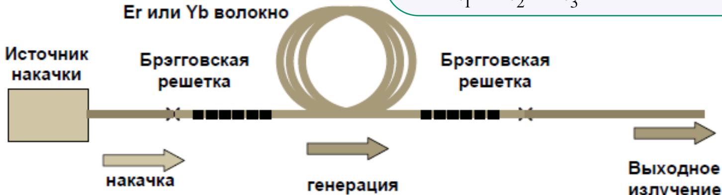
Современная схема волоконного лазера
