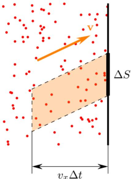
Пусть теперь газ истекает из отверстия площадью  $\Delta S$ .
